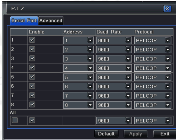
4-37. Ábra: P.T.Z beállítás –soros port
